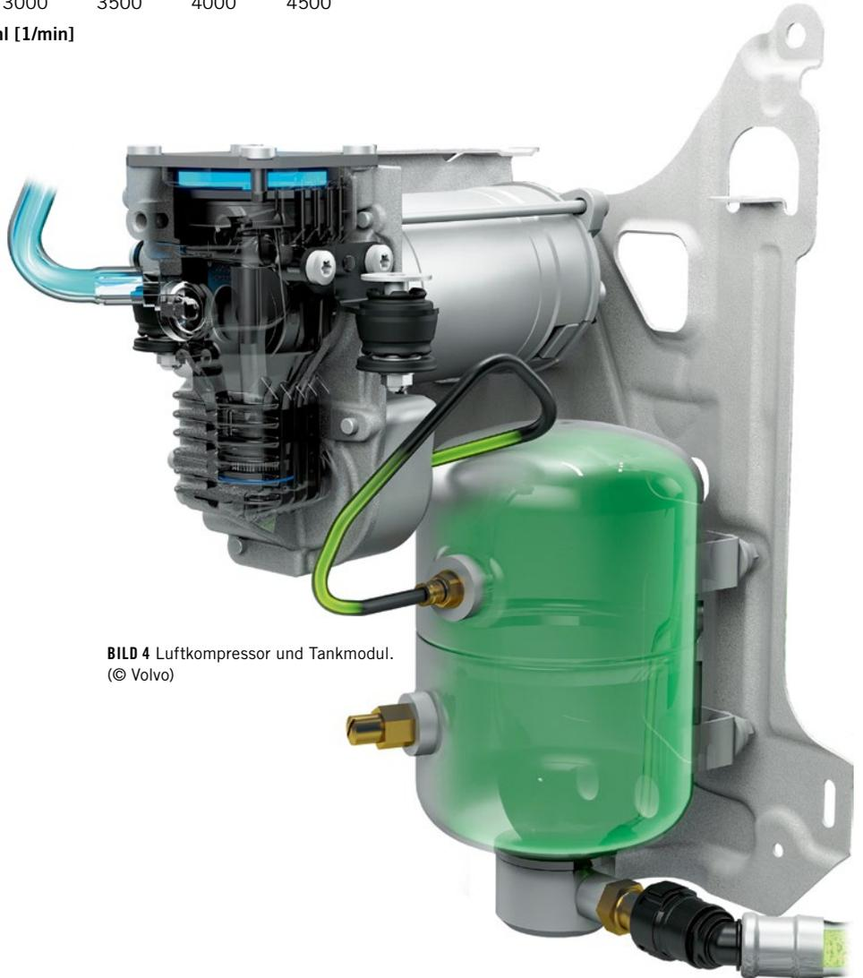
**BILD 4** Luftkompressor und Tankmodul. (© Volvo)
